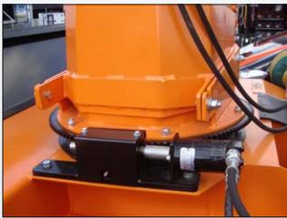
Auswurfkamin hydraulisch drehbar
