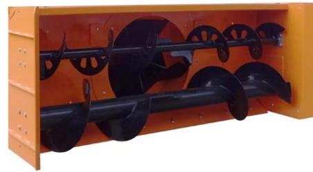
Zuführschnecke und Auswurf-turbine
